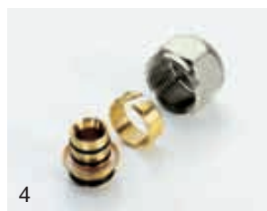
Art. 1636 Jeu écrou + ogive + insert pour insertion tube multicouche AL-COBRAPEX dans fixations 3/4"x18 (Euroconus)
