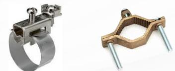
Ce collier pour liaison équipotentielle doit être monté sur un tube rigide susceptible d'être conducteur. En aucun cas monter le collier sur le tuyau pliable ou sur les pans hexagonaux!
