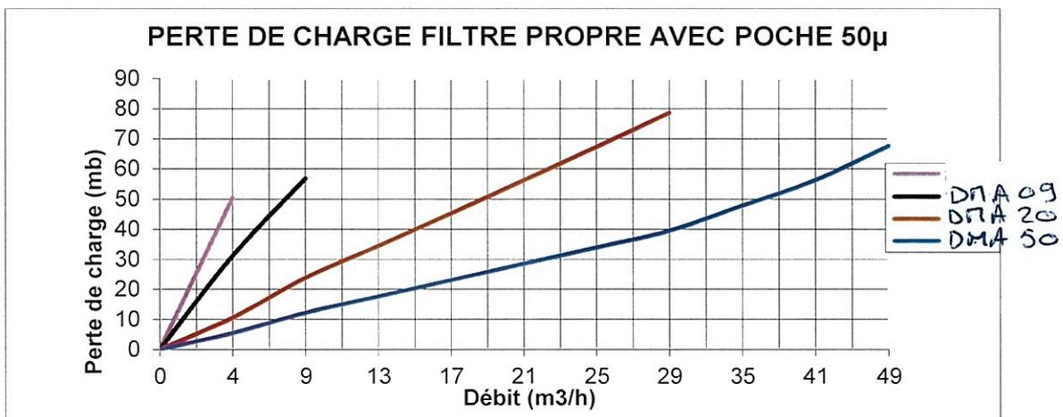
Perte de charge E/S maximale filtre propre
