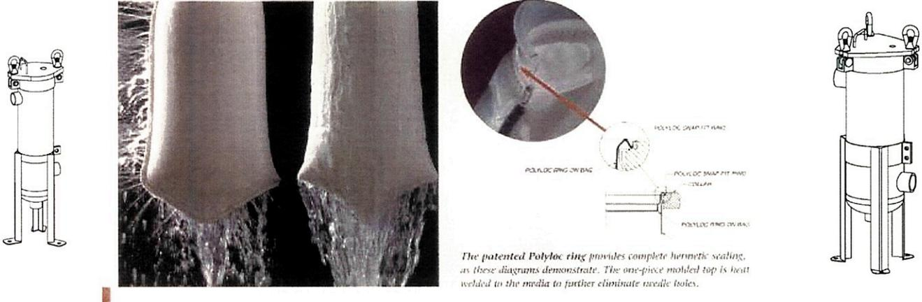
Le système à bague Polyloc garantit une étanchéité parfaite lors du passage du fluide et maintient en place la poche dans la bague spécialement usinée et soudée dans l'appareil. La poche reste parfaitement fixée grâce à l'usinage de la bague support qui est conçue pour résister au différentiel de pression et de cette manière le réseau reste protégé, malgré le colmatage.
